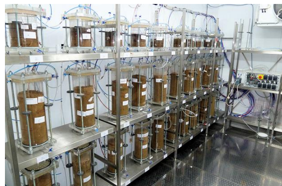
Abb.1: Mesokosmenanlage für eine kontinuierliche Erfassung von Gasflüssen am Thünen-Institut, Braunschweig (© Thünen-Institut/Patrick Wordell-Dietrich)
