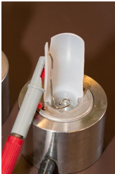
Abb. 1: Apparatur zur elektrochemischen Abscheidung des Americiums/Curiums, (nicht maßstabsgetreu)
