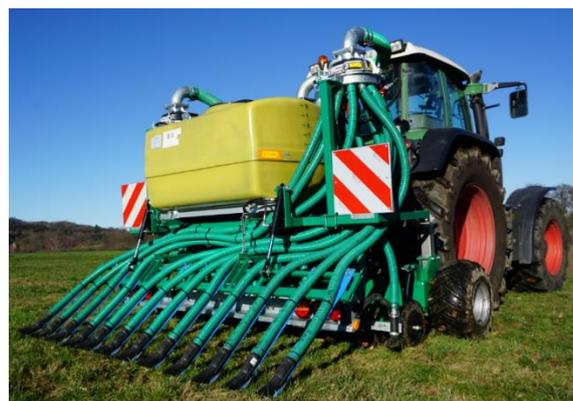
Versuchstechnik für die Ausbringung von Gülle und Gärresten in wachsende Bestände: Schleppschlauch/-schuh bzw. Schlitztechnik
