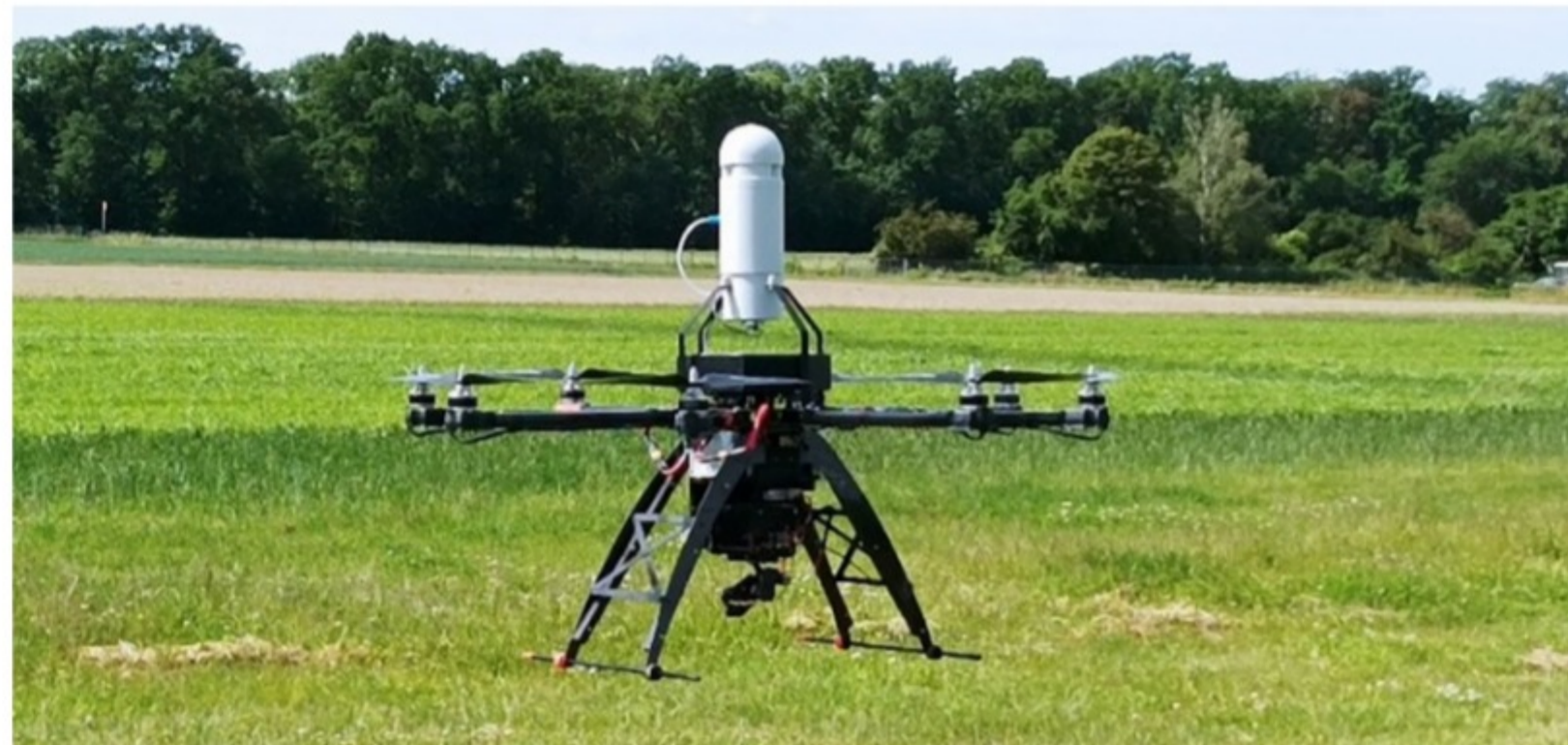
Bild Drohne des Thünen-Instituts (Oktokopter) mit aufgesetzter Messplattform zur Sammlung von Bioaerosolen. Foto: Thünen-Institut/Michael Welling
