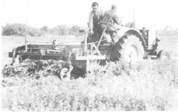
Meyer-Stengelknickmaschine. Dia 77/51 Dient zur Beschleunigung der Heutrocknung. Der gemähte Grünfutterschwaden wird von der Maschine aufgenommen und zwei Walzen zugeführt, mit deren Hilfe die dickeren Stengel gebrochen werden, sodass sie ebenso schnell wie die Blätter trocknen. Die Trocknungszeit kann mit Hilfe dieses Gerätes von 3 auf 2 Tage gekürzt werden.
