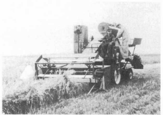
Massey-Harris-Selbstfah­ermäh­drescher. Dieser neue Mäh­drescher-Typ mit frontschneidendem Mähwerk und mit eigener Antriebskraft durch einen eingebauten Verbrennungsmotor führt sich neuerdings auch in Europa ein. Das Bild zeigt die Maschine bei der Haferernte.
