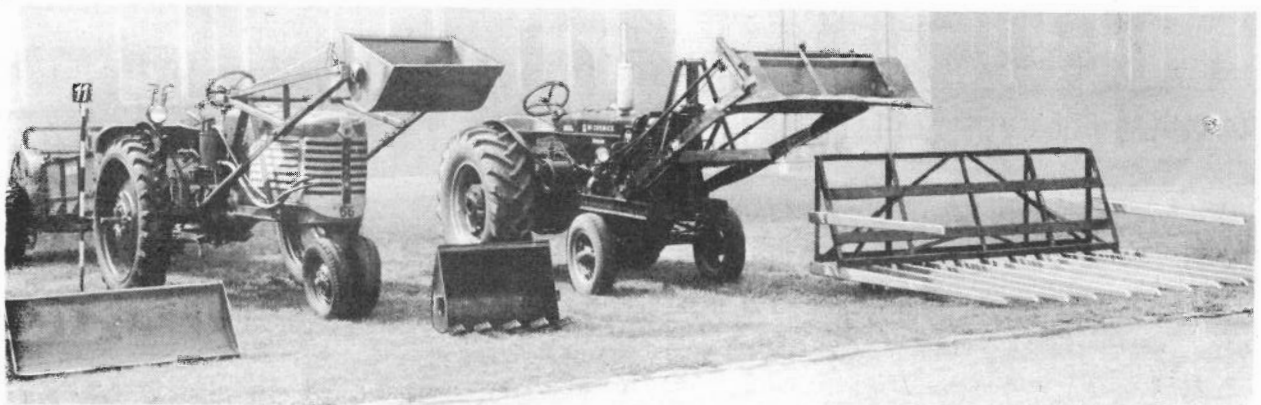
Die Schlepper Oliver und Mc Cormick mit ölhdraulisch getriebenen Ladern für Stallung mit aufgesatteltem Streuwagen (hinter der Nummer 11) bieten für grössere Betriebe Vorteile (besonders Verringerung von menschlicher Arbeitsleistung); durch Anbringung von Erdschaufeln oder Heuladern wird die Hydraulik vielseitig ausgenutzt.
