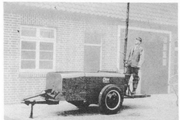
Abb. 8 Dia 92/51 Grössere Motorspritze „46 T R“ der Firma Bean, mit Spray-Boom für automatische Spritzarbeits.
