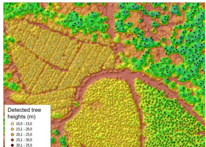
© Grafik: Philip Beckschäfer: Anhand lokaler Maxima eines Vegetationshöhenmodells detektierte Einzelbaumhöhen. Hintergrund: Luftbildbasiertes Vegetationshöhenmodell
