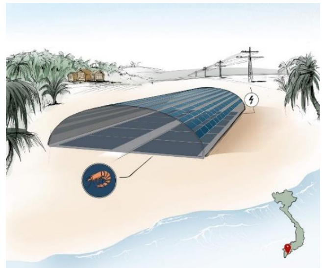
Abbildung 1: Schematische Darstellung einer Aqua-PV-Anlage mit Netzanbindung (Quelle: Fraunhofer-Institut für Solare Energiesysteme).
