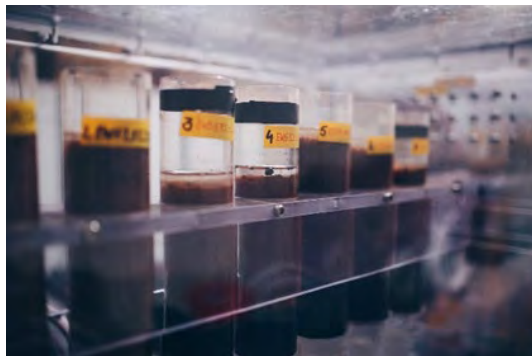
Abb. 8. Inkubationsexperimente zur Quantifizierung des CO 2 -Entnahmepotentials verschiedener Kombinationen von Gesteinsmehl und Pflanzenkohle. (Foto: T. Amann)
