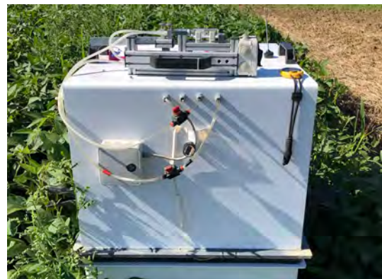
Abb. 91. Lachgasmessung in Sojabohnen mit der Closed-Chamber-Methode.
