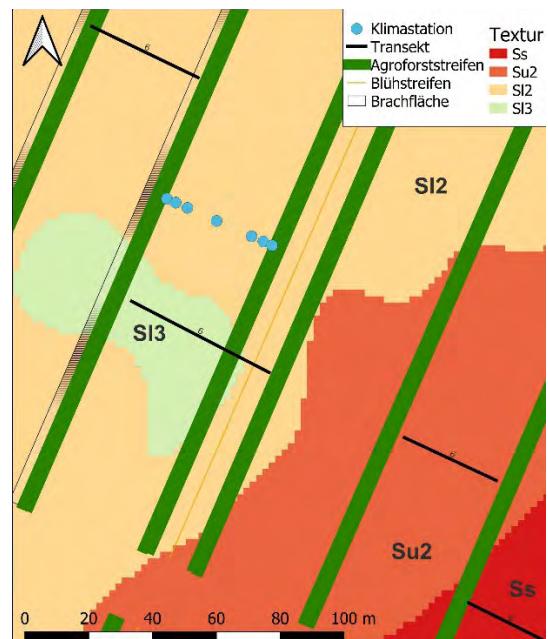
Abb. 78. Texturkarte mit 7 Klimastationen und zahlreichen Messtransekten innerhalb eines Agroforstsystems im Forschungsprojekt DaVaSus.
