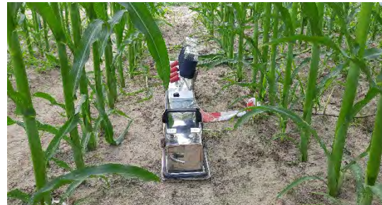
Abb. 64 Messung von bodenbürtigen CH 4 - und N 2 O-Emissionen im Pflanzenbestand
