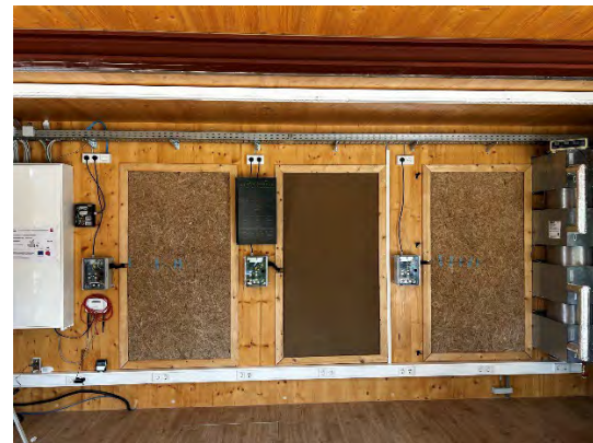
Abb. 47. Testflächen im Energie-Effizienz-Prüfstand Jade Campus Oldenburg - Typha-Dämmplatten (v.l.n.r.: Vollplatten - Vollplatten inkl. Lehmputz - Typha-Sandwichelement mit Typha-Dämmschüttung)
