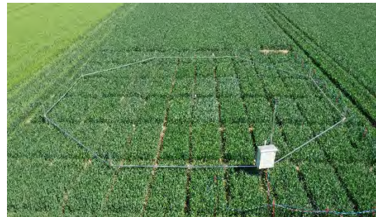
Abb. 81. FACE-Anlage des JKI am Standort Braunschweig-Bundesallee in einem Weizenversuch. Innerhalb des Ringes/Achtecks wird die CO 2 -Konzentration auf 600 ppm erhöht.
