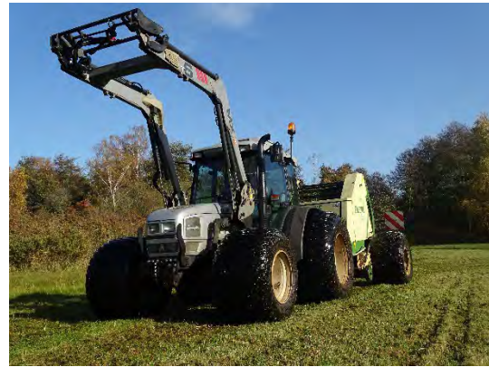
Abb. 51. Landwirtschaft auch bei hohen Wasserständen: Erreichbar durch geringe Radlast und breite Reifen. Zu sehen ist ein Lamborghini mit der Rundballenpresse Krone KR 160.
