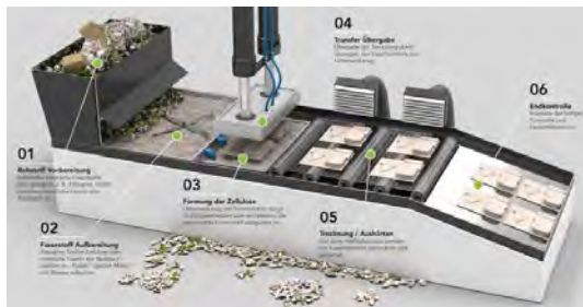
Abb. 43. Herstellungsprozess eines Faserformteils (Faserguss) im Nassverfahren.
