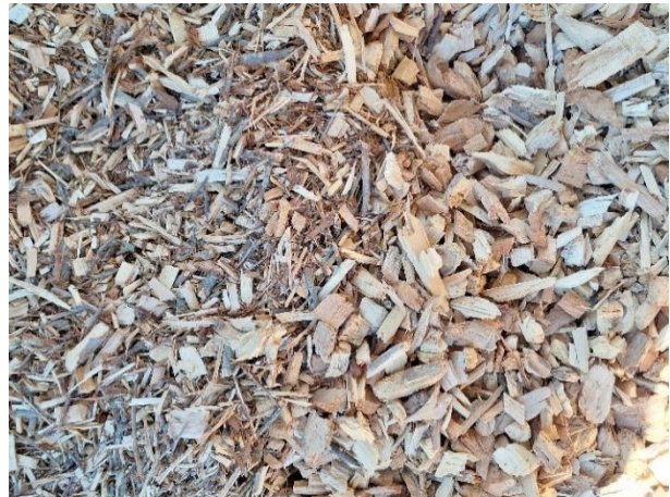
Abbildung 1: Sichtbar uneinheitliches Hackschnitzelmaterial aus der Knickpflege; links mit höherem Strauchanteil (© Marion Kruse / Thünen-Institut für Ökologischen Landbau)
