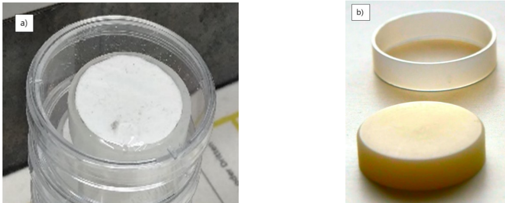
Abb. 2: a) Messpräparat, bestehend aus Kunststoffscheibe, Fixierring und Filterpapier mit Niederschlag und Mylar®-Folie, in einer Petrischale b) Kunststoffscheibe und Fixierring
