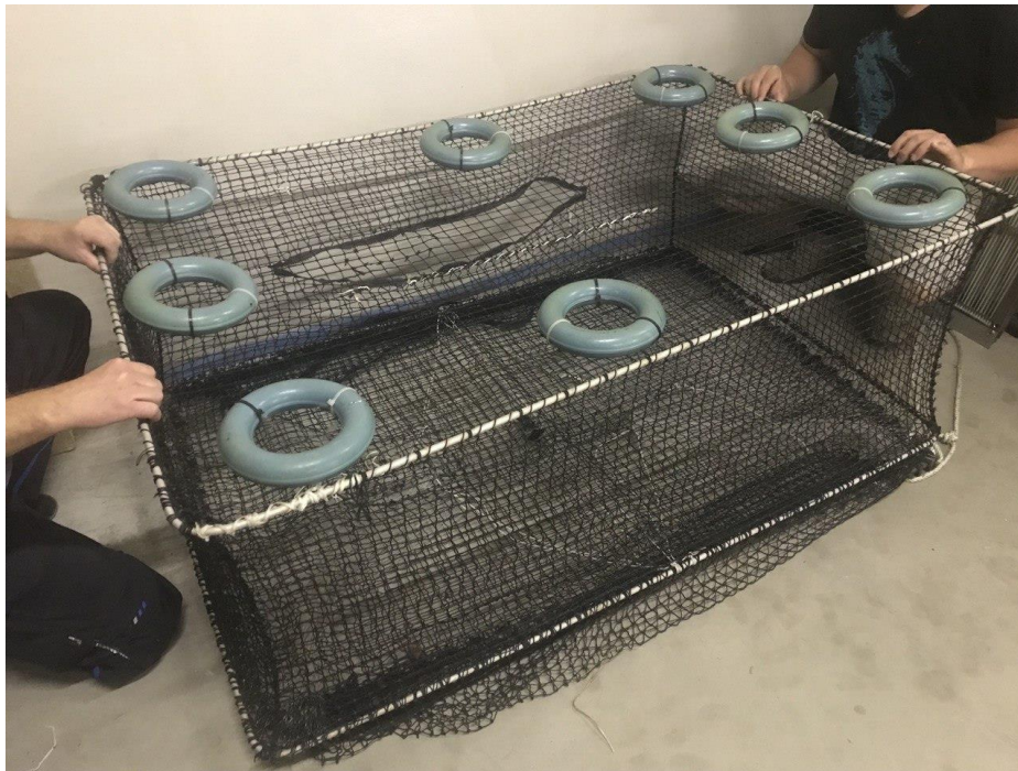
Abbildung 6: Beispiel eines Netzkäfigs (150 cm × 100 cm × 60 cm), der für die 6 bis 7-tägige Hälterung der Plattfische im Feldexperiment eingesetzt wurde.
