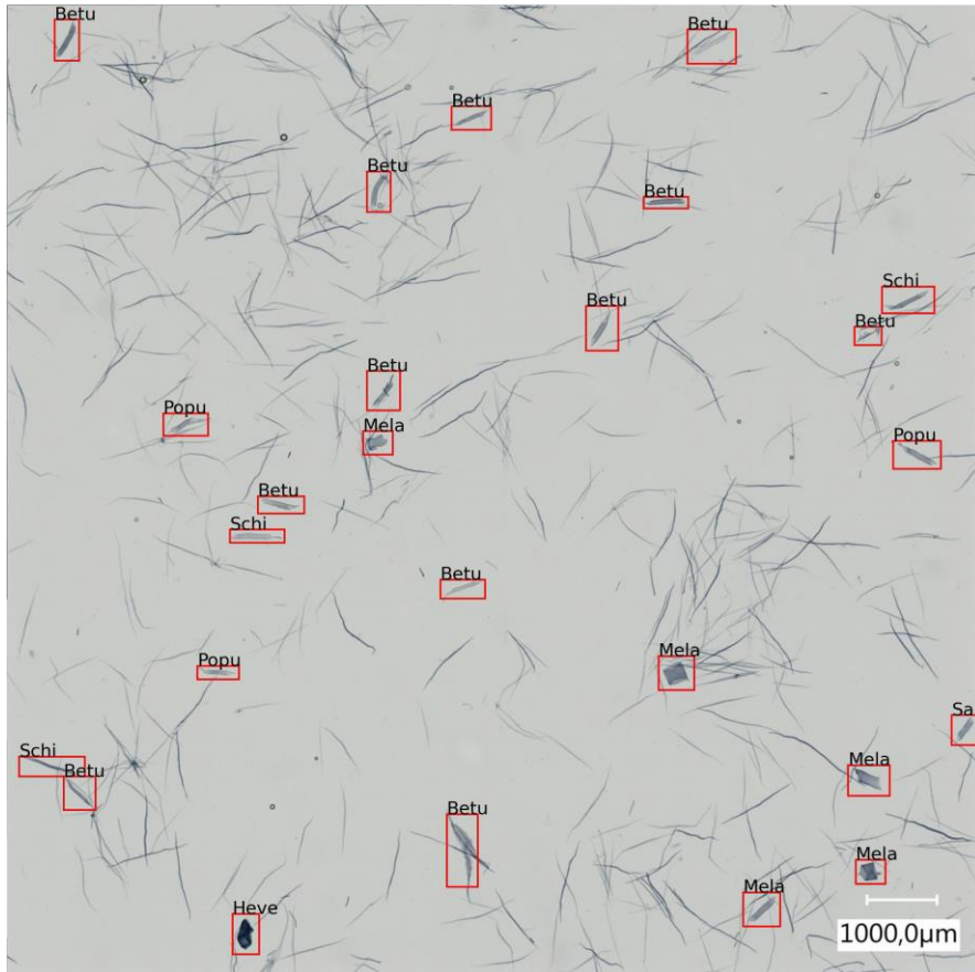
Abbildung 12 Ein typisches Ergebnisbild der KI-Verfahren. Jedes gefundene Gefäß wird umrandet. Die Klassifikation jedes Gefäßes wird über den Rechtecken in Kurzform angezeigt. Optional kann noch die Klassifikationswahrscheinlichkeit dargestellt werden.
