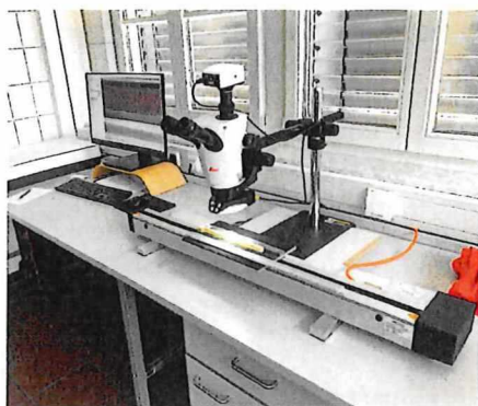
Abb. 3: Digitalisierung und Vermessen der Bohrkern im Labor
