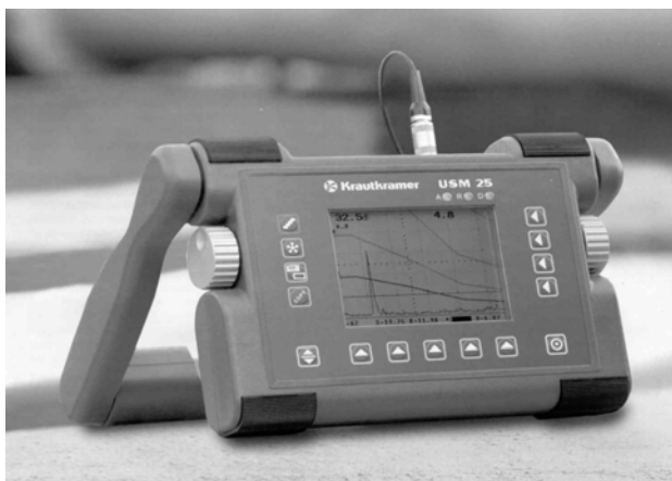
Abbildung 10: Display eines Ultraschallmessgerätes und Ergebnisdarstellung der Messung einer Rückenspeckdicke in grafischer und digitaler Form (HESSE et al., 2003)
