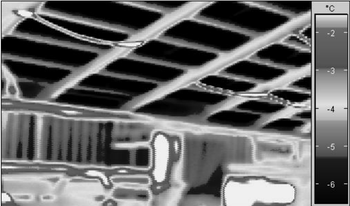
Abbildung 12: Temperaturbereiche in einem Versuchsgebäude für Rinder auf der VSB – dargestellt mit Thermografiertechnik (GEORG und UDE, 2002)
