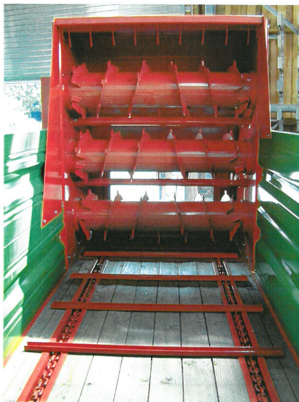
Bild 13: Ballen-Auflösesystem des HAWE Strohverteilwagens SVW II R mit Kratzboden für die Ballenzuführung
