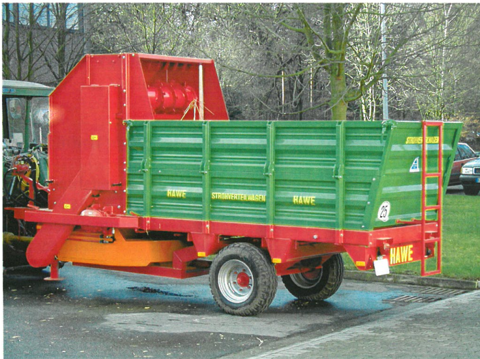
Bild 12: HAWE Strohverteilmwagen SVW II R zum Auflösen unterschiedlicher Strohballen und verteilenden Auswerfen zum Einstreuen in Ställen, Abdecken von Mieten u. a. (hier Auswurf in Fahrtrichtung vorn rechts unten)
